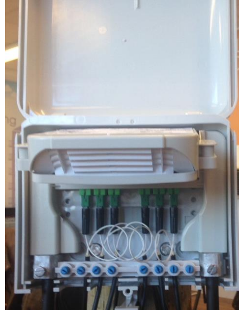
Figure 14 PB préconnectorisé 6 branchements maximum
