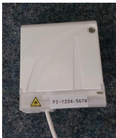
Figure 2 : repérage sur la prise mono fibre
