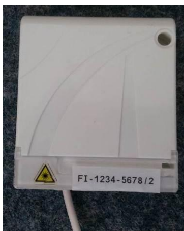
Figure 3 : repérage de la PTO déportée
